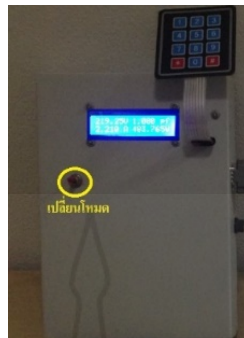
รูปที่ 7 โหมดแสดงผลข้อมูลทางไฟฟ้า
